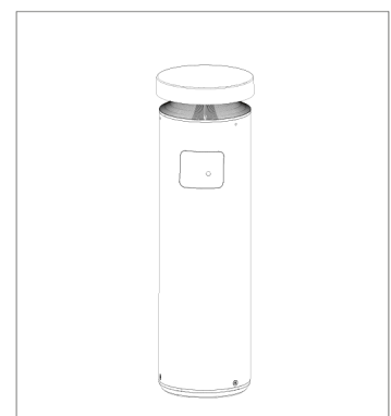
10. Pollerleuchte an Befestigungsplatte anbringen (Sensor-Richtung berücksichtigen)
