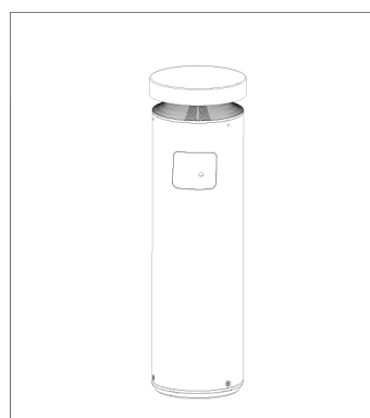
10. Pollerleuchte an Befestigungsplatte anbringen (Sensor-Richtung berücksichtigen)
